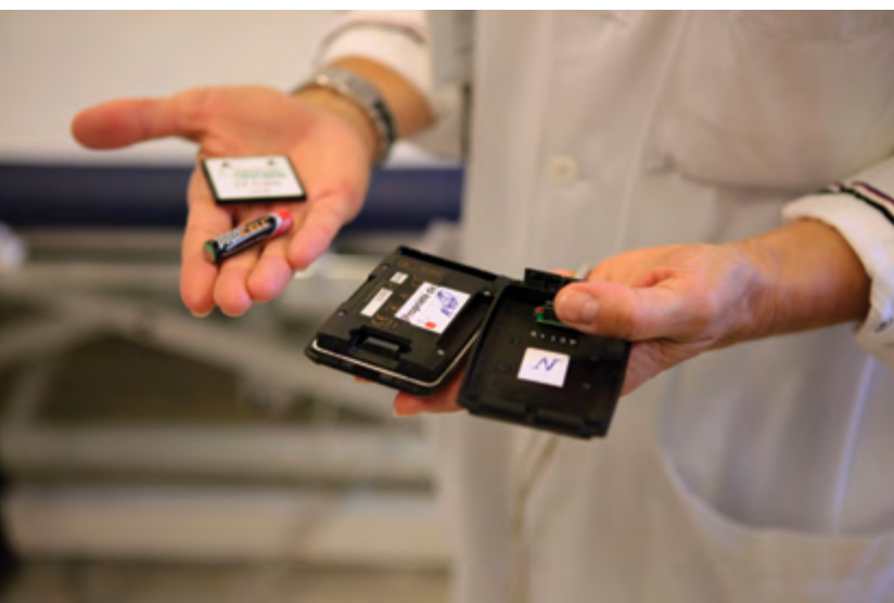
Une pile et une carte mémoire : le contenu du boîtier d'enregistrement pour l'ECG longue durée.
